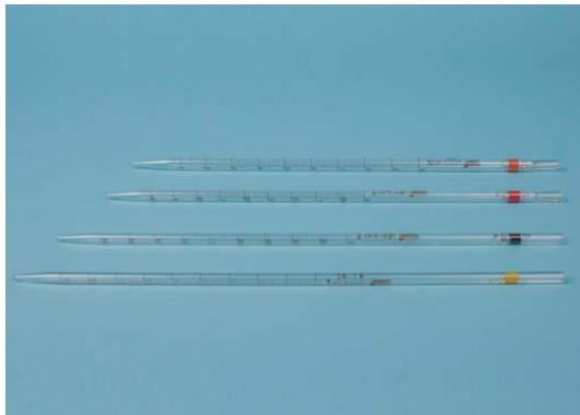
**1** Con graduación ámbar de abajo a arriba (cero en la parte superior) y marcas circulares en puntos principales.
